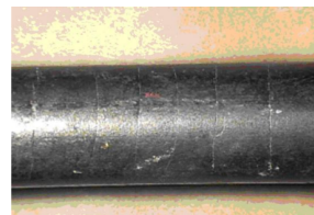
Pęknięcie amoniakalne stopu 5Cr-0,5Mo
