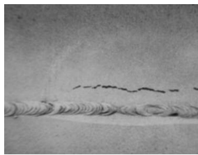
Pęknięcie węglanowe przyspoinowe
