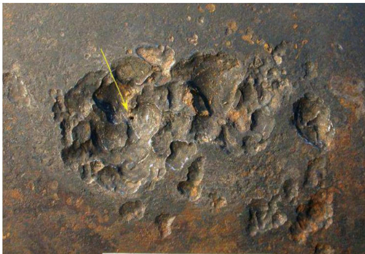
Fot 4.20B. Obraz uszkodzenia w wyniku oddziaływania indukcyjnego linii wysokiego napięcia
