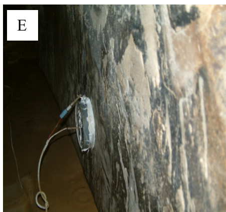
Fot. 2.1. A) Widok absorbera, B) Schemat budowy adsorbera, C) pomiar twardości wykładziny gumowej, D) Schemat budowy celki pomiarowej, E) celka na badanej wykładzinie gumowej, F) Wyznaczone widma impedancyjne wykładziny spenetrowanej (strefa duktów) i wykładziny niespenetrowanej (dolna część absorbera)
