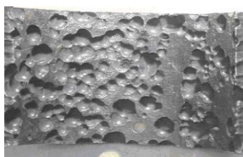
Pylenie metalu. Rura pieca ze stali 304
