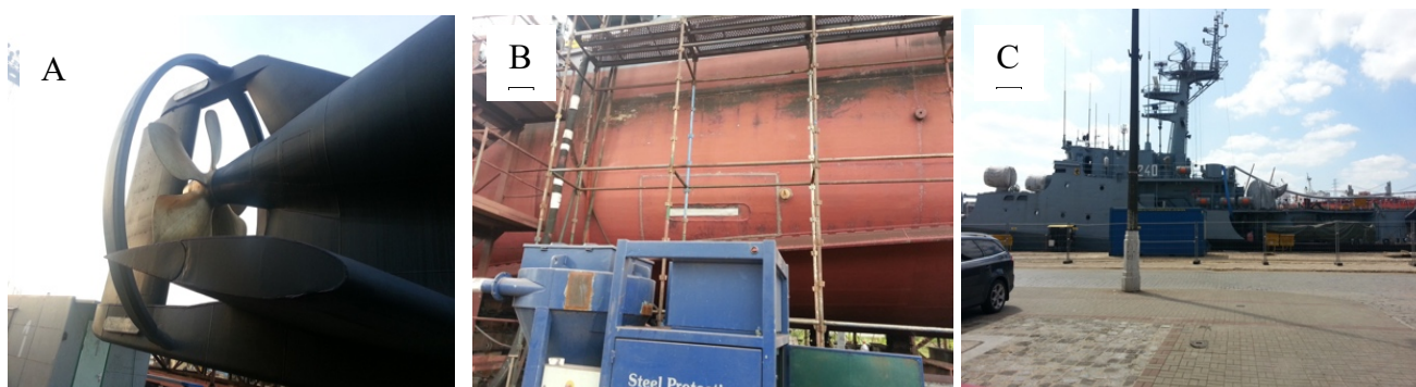
Fot. 4.14. A) Pędnik łodzi podwodnej, B) Okręt w suchym doku na burcie okrętu z widocznym ekranem, na którym widoczna jest anoda, C) Okręt wojny przy kei w czasie prób polaryzacyjnych.
