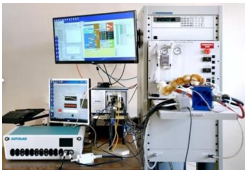
Fot. 4.11B. Cyfrowy system pomiaru Dynamicznej Elektrochemicznej Spektroskopii Impedancyjnej zbudowany na bazie kart pomiarowych National Instruments sprzężony ze stacją testową wodorowych ogniw paliwowych.
